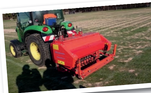
Pro Quadratmeter werden rund 300 20 bis 25 cm tiefe Löcher in den Rasen gestanzt
